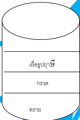
ภาพที่ 4.13 ตัวอย่างเครื่องกรองอย่างง่ายและสัดส่วนของวัสดุที่ใช้ในการกรอง
