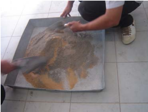
ภาพที่ 3.3 ชุดตัวอย่างผสมตะกรันสัดส่วนร้อยละ 20 ลงในวัสดุผสมที่เตรียมไว้
