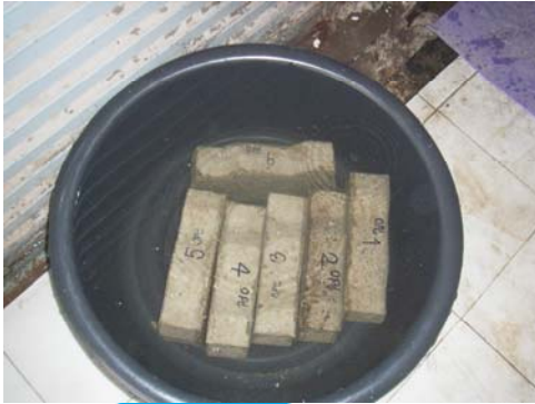
ภาพที่ 3.8 ทำการบ่มในน้ำ
