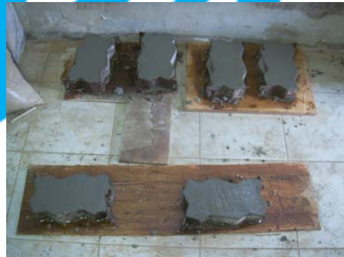
ภาพที่ 3.6 ทำการสั่นแบบ กระทบคองกรีตจนเนื้อคองกรีตแน่นสม่ำเสมอ แล้วปาดผิวหน้าให้เรียบ
