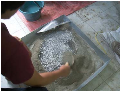
ภาพที่ 3.2 ผสมปูนซีเมนต์ ทราช และหินเกล็ดตามสัดส่วนลงในกะบะ เป็นชุดควบคุม (Control)
