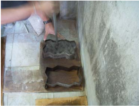
ภาพที่ 3.5 เทส่วนผสมลงในแบบหล่อที่เตรียมไว้
