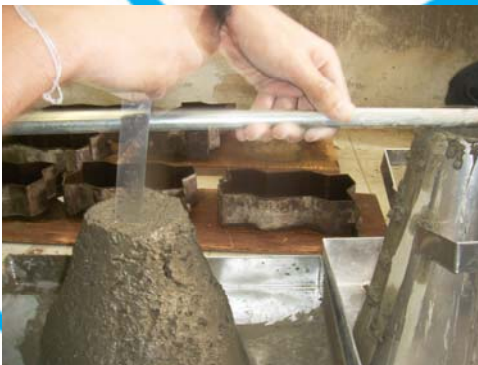
ภาพที่ 3.4 ทำ Slump Test เพื่อหาความต้องการน้ำ และการยุบตัวของปูนซีเมนต์
