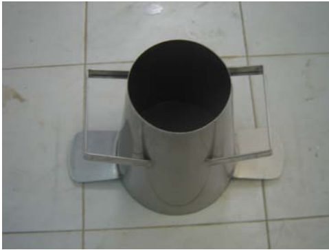
ภาพที่ ก-7 Slam Test
