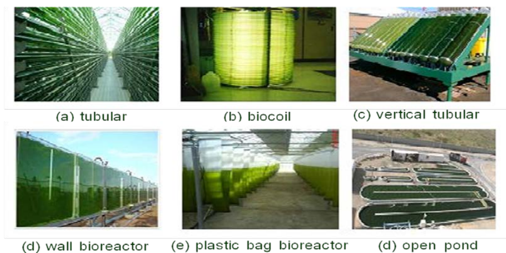
ภาพที่ 2.10 ถังหมักแบบใช้แสง (Photobioreactors) สำหรับการเพาะเลี้ยงสาหร่ายขนาดเล็ก
