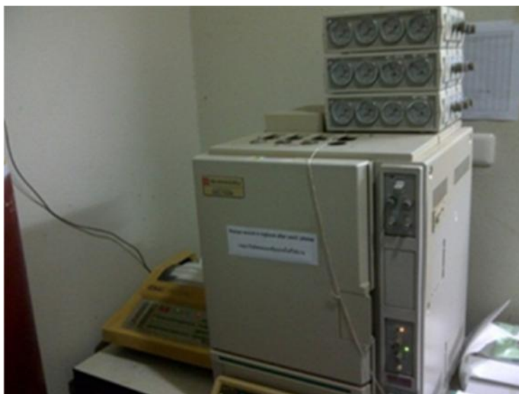
ภาพที่ 3.5 เครื่องแก๊สโครมาโทกราฟฟีรุ่น SHIMADZU GC- 14b
