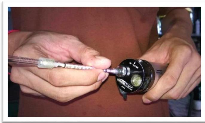
รูปที่ ค.3 การต่อ gas detector tube เข้าไปใน air sampling pump
