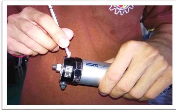
รูปที่ ค.2 การหักปลายของ gas detector tube
