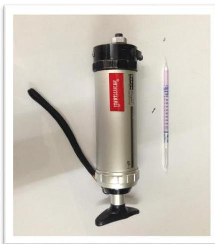
รูปที่ ค.1 ลักษณะของ Kitagawa Gas Detector Tube System
