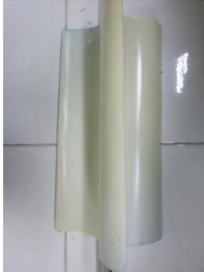
รูปที่ 3.3 ไบพัดที่เคลือบด้วยไทเทเนียมไดออกไซด์
