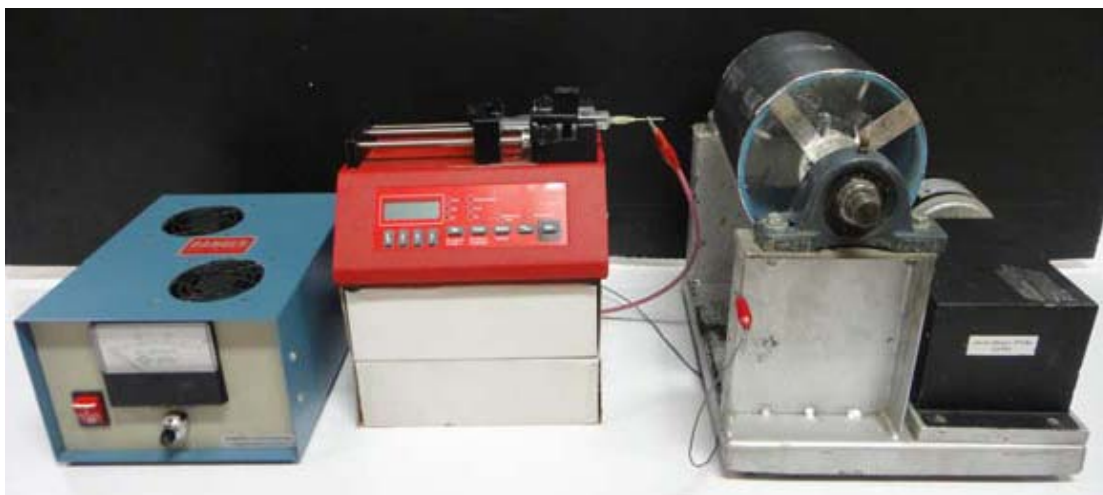
ภาพที่ 3.1 ชุดอุปกรณ์การปั่นเส้นใยด้วยไฟฟ้าสถิตที่ใช้ในงานวิจัย
