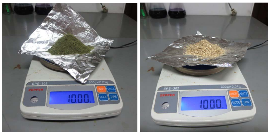
ภาพที่ 3.4 ชั่งผงละเอียด 10 กรัม เพื่อละลายในน้ำ 100 มิลลิลิตร
