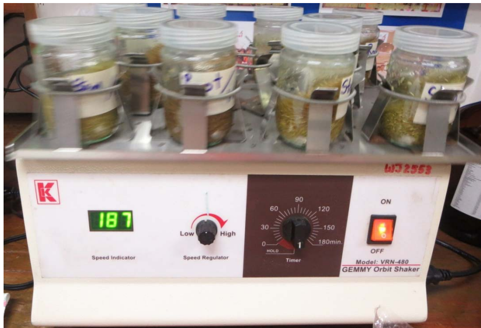
ภาพที่ 3.6 การเขย่าส่วนผสมโดยเครื่อง orbital shaker
