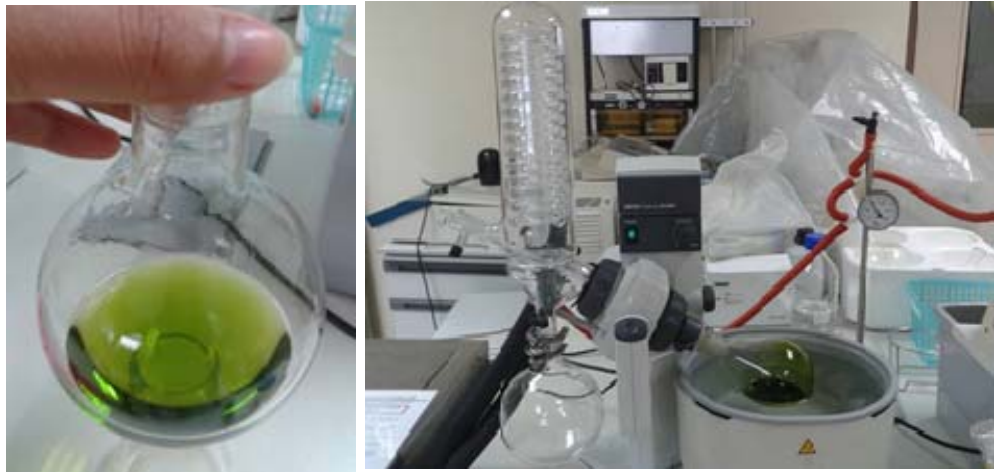
ภาพที่ 3.9 การระเหยตัวทำละลายออกโดยวิธี evaporation
