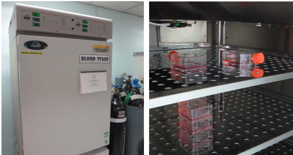
ภาพที่ 4.2 ตู้ป่มเชื้อมาลาเรีย; ควบคุมอุณหภูมิที่ 37°C
