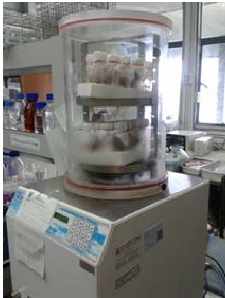
ภาพที่ 3.9 ขั้นตอนการทำให้เป็นผงแห้งโดยวิธี lyophilization
