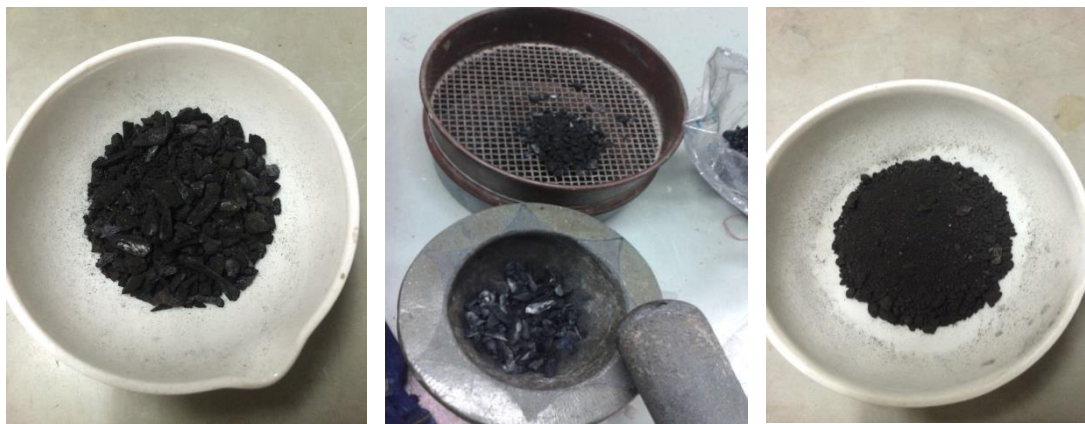
ภาพที่ ข-3 ทับกระดูกหมูและกระดูกไก่ที่เผาที่ในอุณหภูมิ 500 °C
