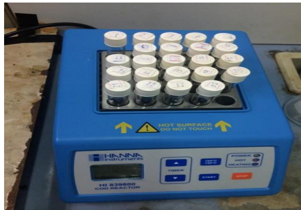
ภาพที่ ข- 12 ย่อยด้วยเครื่อง(Digestion apparatus)
