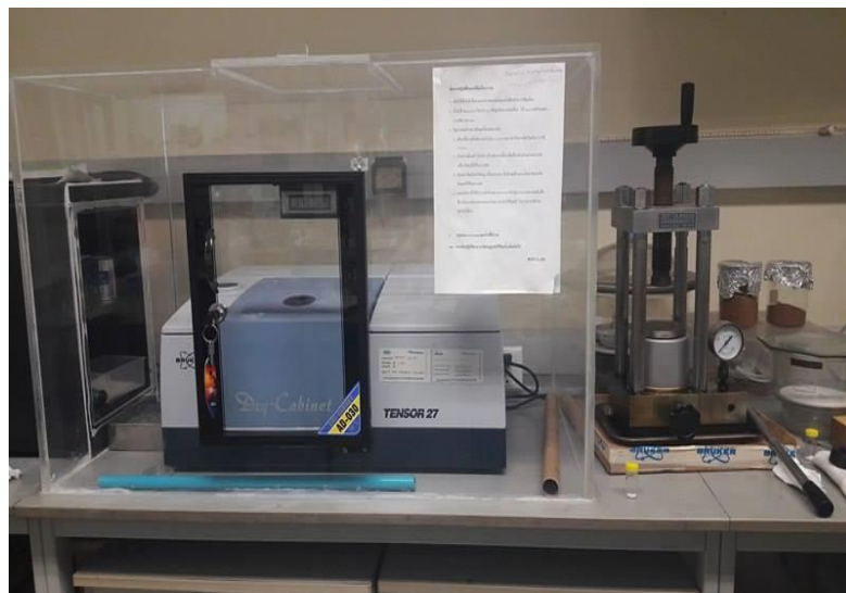
ภาพที่ ข-17 เครื่อง Fourier Transform Infrared Spectroscopy (FT-IR)
