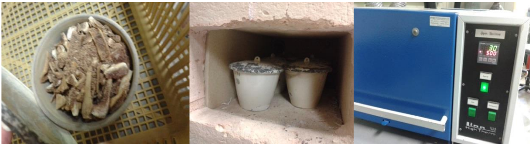
ภาพที่ ข-2 นำกระดูกหมูและกระดูกไก่เผาในอุณหภูมิ 500 °C
