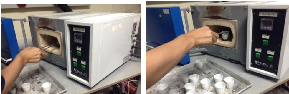
ภาพที่ ข-11 เตาเผาอุณหภูมิสูง (muffle furnace)
