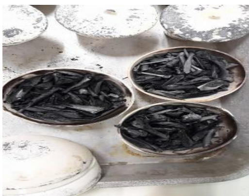
ภาพที่ 3.4 กระดูกหมูและกระดูกไก่หลังเผาที่อุณหภูมิ 500 องศาเซลเซียส
