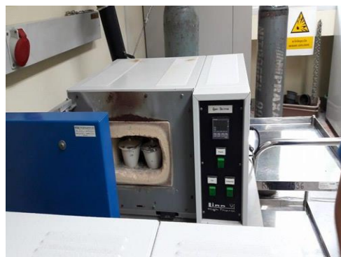
ภาพที่ 3.3 กระดูกหมูและกระดูกไก่ก่อนเผาที่อุณหภูมิ 500 องศาเซลเซียส
