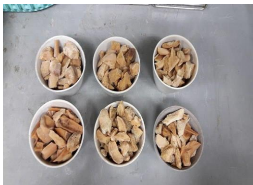
ภาพที่ 3.3 กระดูกหมูและกระดูกไก่ก่อนเผาที่อุณหภูมิ 500 องศาเซลเซียส
