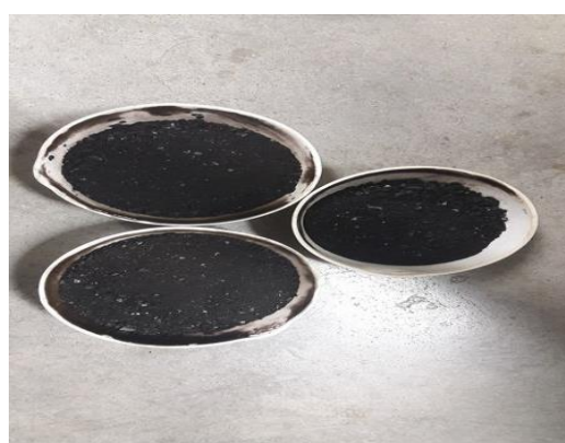
ภาพที่ 3.4 กระดูกหมูและกระดูกไก่หลังเผาที่อุณหภูมิ 500 องศาเซลเซียส
