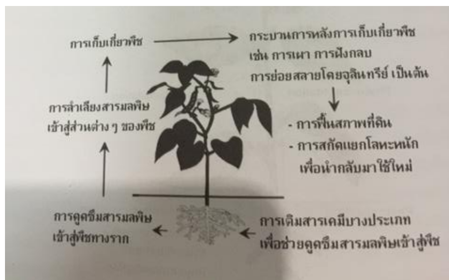
ภาพที่ 2.2 กระบวนการโดยรวมของ Phytoaccumulation หรือ Phytoextraction (อลิสสา, 2554)
