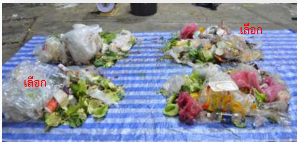
ภาพที่ 3.2 การแบ่งมูลฝอยออกเป็น 4 ส่วน และเลือกส่วมเอามา 2 ส่วนที่อยู่ตรงข้ามกัน
