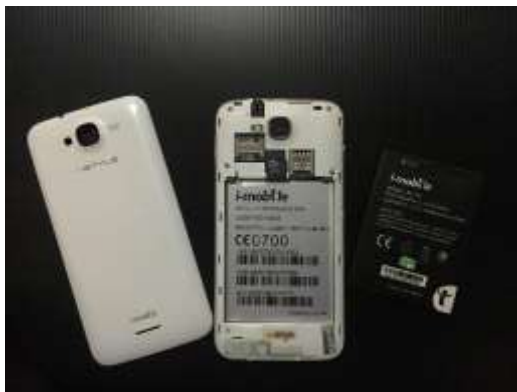
ภาพที่ 2.1 ส่วนประกอบหลักของโทรศัพท์มือถือ (คณะผู้วิจัยถ่ายเอง)
