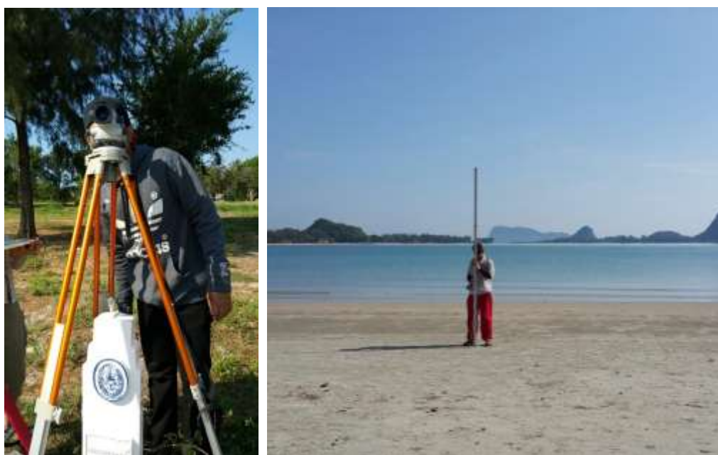
ภาพที่ 3.2 กล้องวัดระดับและอุปกรณ์ที่ใช้ในการศึกษาความสูงของพื้นที่
