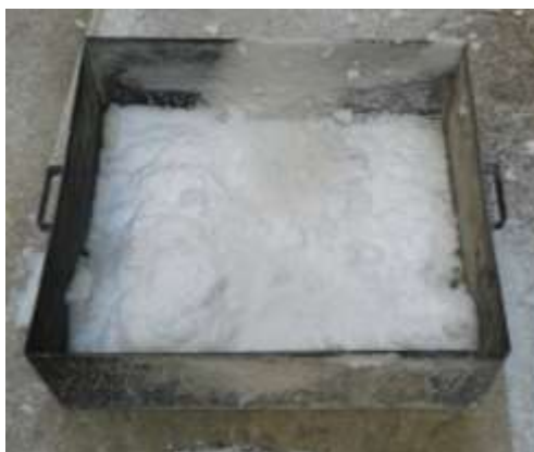
ภาพที่ 4.4 ลักษณะฟองโฟมหลังจากทำการทดสอบสารดับเพลิงประเภทโฟมโปรตีนสังเคราะห์ที่จำหน่ายในท้องตลาด
