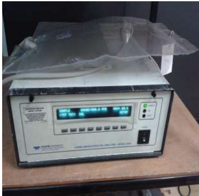
ภาพที่ ก-11 วิเคราะห์ก๊าซออกไซด์ของไนโตรเจนด้วยเครื่อง NOx Analyzer
