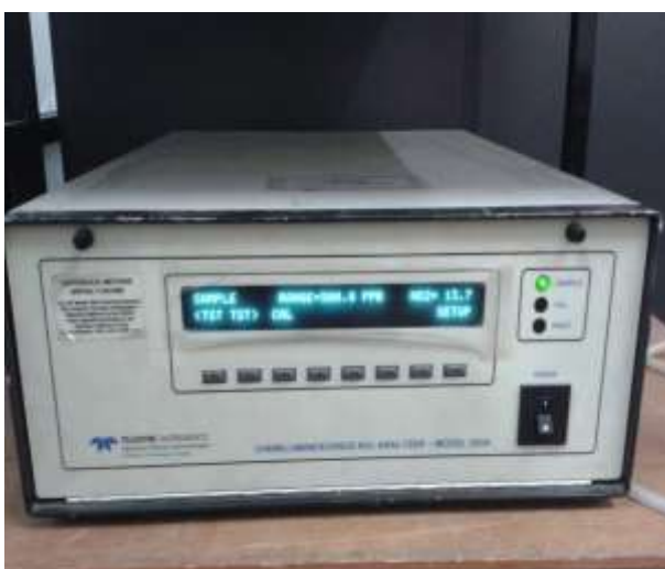
ภาพที่ 3.10 เครื่องวิเคราะห์ความเข้มข้นของก๊าซออกไซด์ของไนโตรเจน
