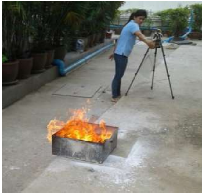
ภาพที่ ก-9 การตรวจวัดก๊าซคาร์บอนมอนอกไซด์และก๊าซออกไซด์ของไนโตรเจน
