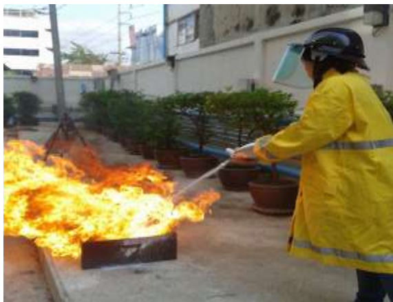
ภาพที่ 4.5 การทดสอบประสิทธิภาพสารดับเพลิงประเภทโปรตีนสกัดจากกากเนื้อในเมล็ดยางพาราในภาคสนาม
