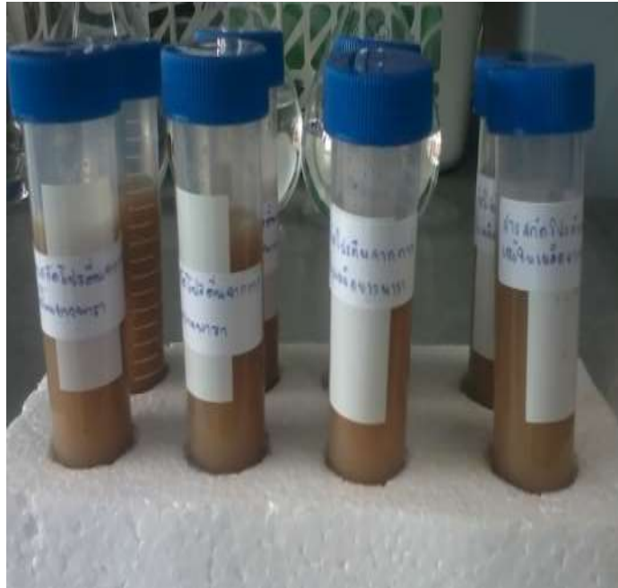
ภาพที่ ก-5 สารสกัดโปรตีนจากกากเนื้อในเมล็ดยางพาราในหลอดเซ้นติฟิว (Centrifuge Tube)
