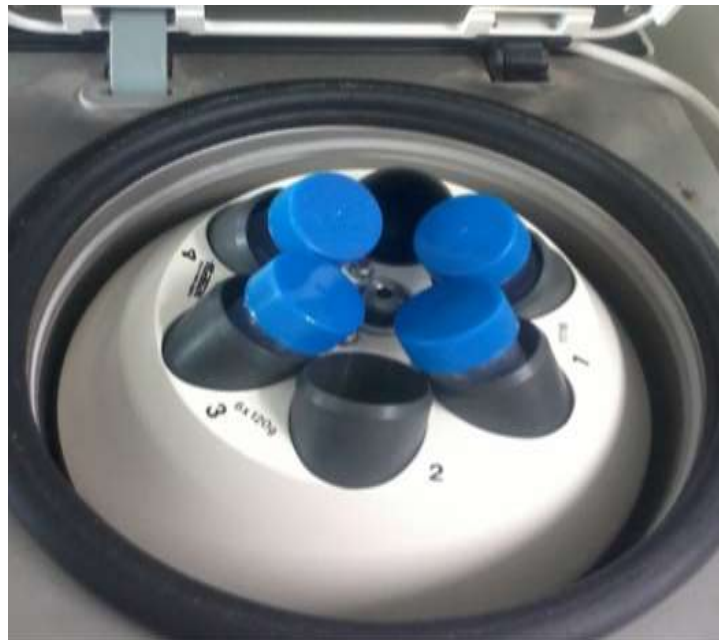
ภาพที่ ก-6 การปั่นหมุนเหวี่ยงเพื่อแยกสารสกัดโปรตีนจากกากเนื้อในเมล็ดยางพารา
