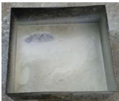
ภาพที่ 4.2 ลักษณะฟองโฟมหลังจากทำการทดสอบสารดับเพลิงโปรตีนจากกากเนื้อเมล็ดยางพาราที่ไม่ใส่ไมโครไนซ์ซิงค์ออกไซด์
