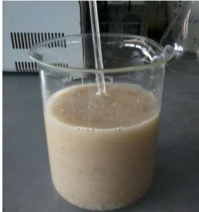
ภาพที่ ก-3 การละลายสารละลายโซเดียมไฮดรอกไซด์กับกากเนื้อในเมล็ดยางพารา
