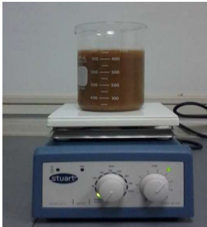
ภาพที่ ก-4 การกวนสารสกัดโปรตีนจากกากเนื้อในเมล็ดยางพาราด้วยเครื่องกวนสาร
