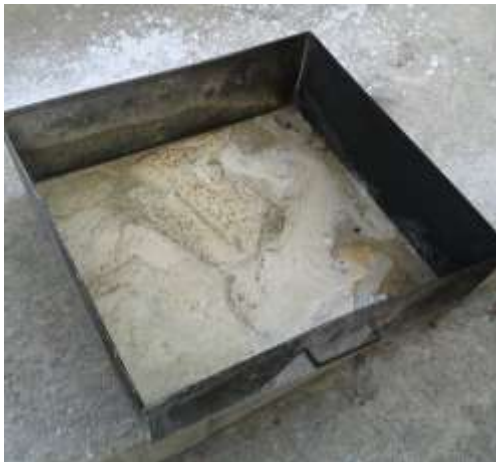
ภาพที่ 4.3 ลักษณะฟองโฟมหลังจากทำการทดสอบสารดับเพลิงโปรตีนจากกากเนื้อเมล็ดยางพาราที่ไม่ใส่ไมโครไนซ์ซิงค์ออกไซด์
