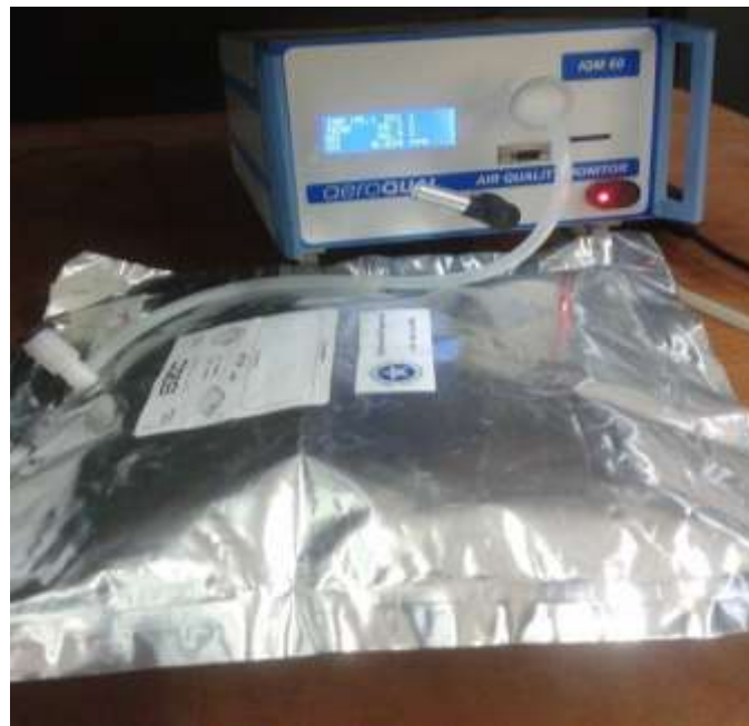
ภาพที่ ก-10 การวิเคราะห์ก๊าซคาร์บอนมอนอกไซด์ ด้วยเครื่อง CO Analyzer
