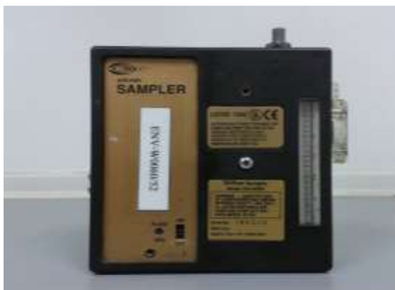
ภาพที่ 3.7 เครื่องเก็บตัวอย่างอากาศส่วนบุคคล
