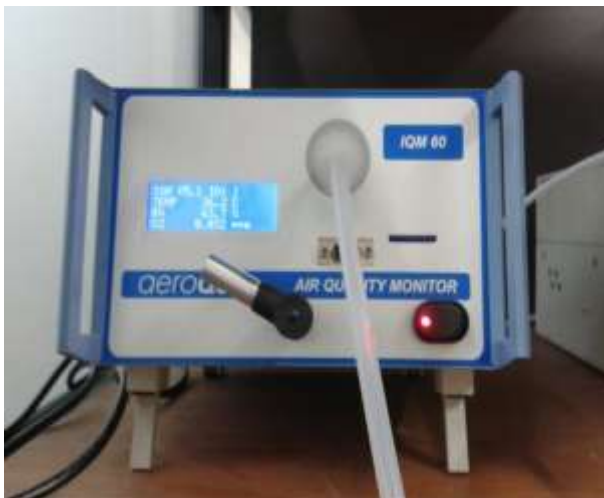
ภาพที่ 3.9 เครื่องวิเคราะห์ความเข้มข้นของก๊าซคาร์บอนมอนอกไซด์
