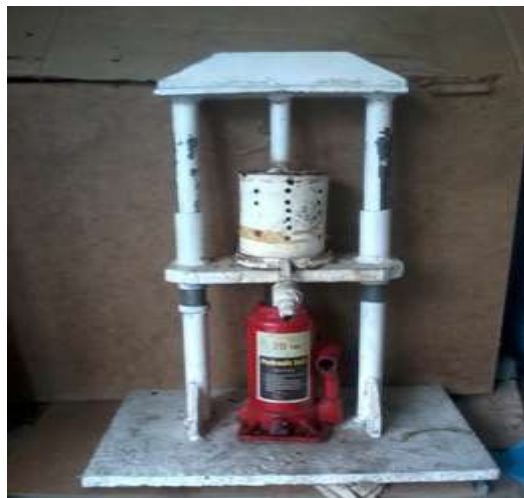
ภาพที่ 3.2 เครื่องบีบอัดแบบไฮดรอลิก ใช้ในการบีบน้ำมันออกจากเมล็ดยางพารา
