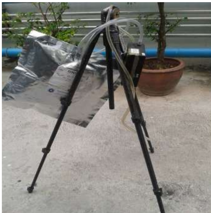
ภาพที่ ก-8 การเก็บตัวอย่างก๊าซคาร์บอนมอนอกไซด์และก๊าซออกไซด์ของไนโตรเจน
