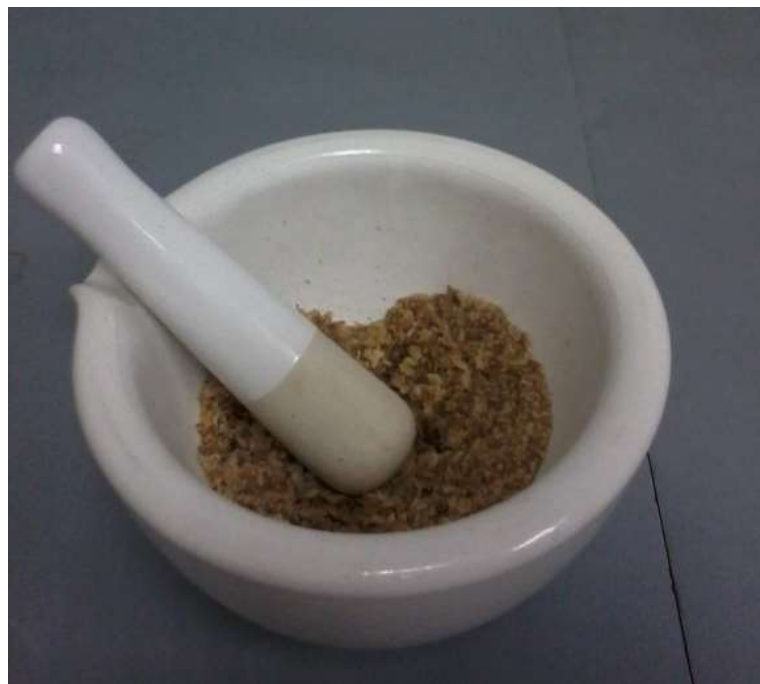
ภาพที่ ก-2 การบดกากเนื้อในเมล็ดขี้พาราด้วยโถงบดสาร
