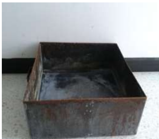
ภาพที่ 3.6 ภาตสี่เหลี่ยมจัตุรัสขนาด 475x 475 มิลลิเมตร ใช้ในการจำลองกองเพลิง
