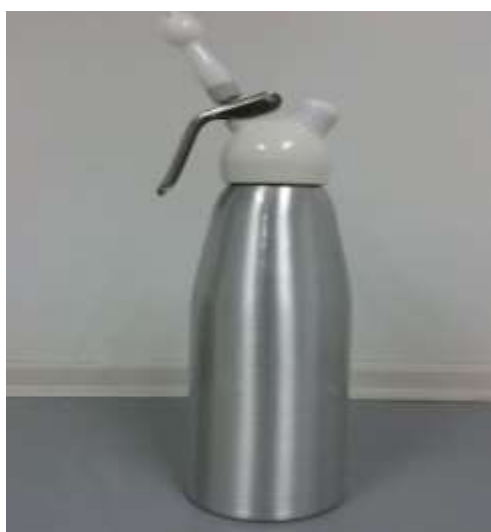
ภาพที่ 3.5 กระบอกอัดอคูมิเนียมที่ใช้ในการบรรจุสารดับเพลิง
