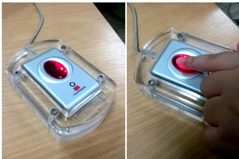
ภาพที่ 3.1 เครื่องสแกนลายนิ้วมือชนิดอินฟราเรดที่ใช้ในการตรวจวัดลายนิ้วมือเด็ก
