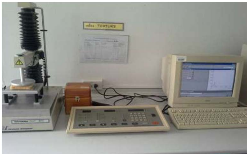
ภาพที่ ข-1 เครื่องวัดเนื้อสัมผัส (Texture analyzer)
