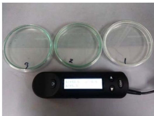
ภาพที่ ข-2 เครื่องวัดค่าสี (Handy colorimeter NR-3000, Japan)
