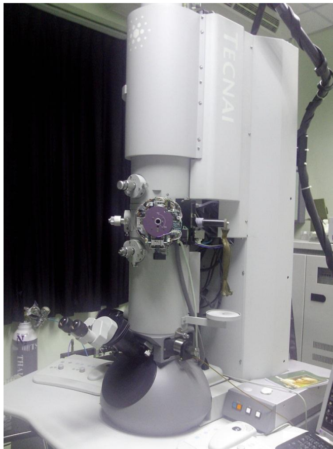
ภาพที่ ข. 1 TEM (Transmission Electron Microscope) ยี่ห้อ FEI รุ่น TECNAI T20 G 2
