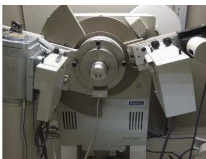
ภาพที่ ค. 6 แสดงส่วนประกอบภายในของเครื่อง XRD ที่ใช้ในการทดลองนี้
