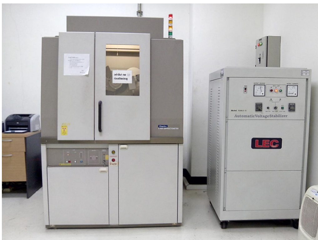
ภาพที่ ค. 7 แสดงเครื่อง XRD ที่ใช้ในการทดลองนี้
