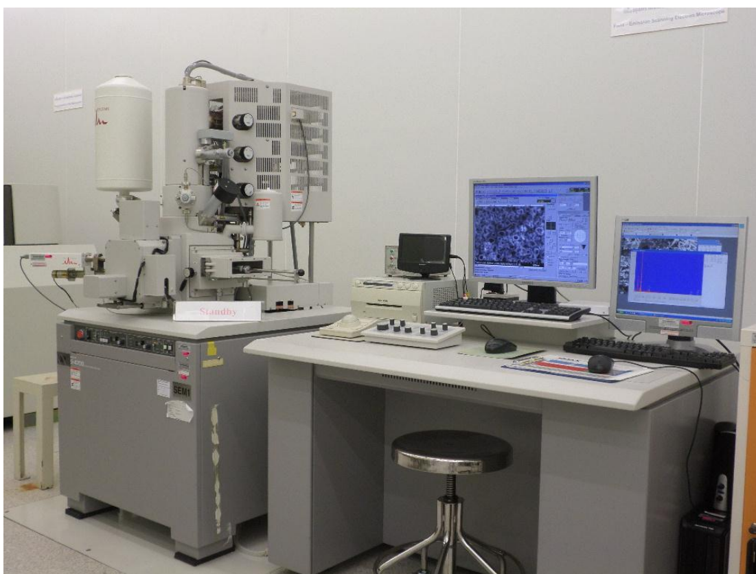
ภาพที่ ก. 1 กล้องจุลทรรศน์อิเล็กตรอนแบบส่องกราดชนิดฟิลด์อิมิชั่นรุ่น FE-SEM MODEL: HITACHI – S4700 ที่ใช้ในงานวิจัยนี้
