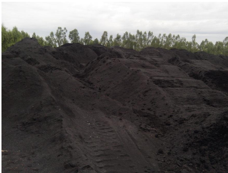
ภาพที่ 1. 4 แสดงตัวอย่างของเสียถ่านโค้กที่เหลือจากการปั่นไฟโรงไฟฟ้าชีวมวล
