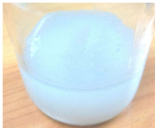
ข) สารแขวนลอยที่เตรียมด้วยการไดอะไลซิส สารละลายเอทิลเซลลูโลสในน้ำกลั่น
