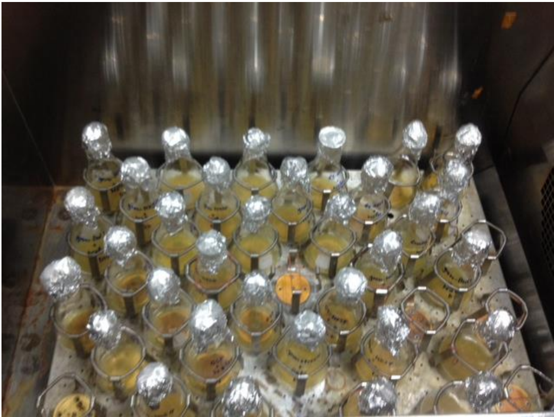
ภาพที่ จ-7 การนำเชื้อจุลินทรีย์ที่เลี้ยงในอาหารเลี้ยงเชื้อมาเขย่า ในเครื่องเขย่า (shaker)
