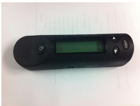
ภาคผนวก ก 1 เครื่องวัดสี Portable colorimeter Instruction Manual
