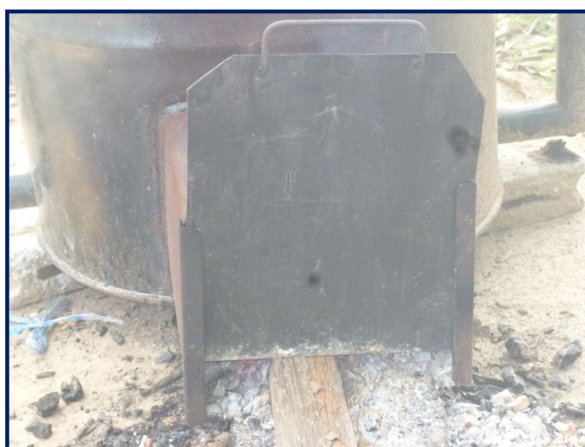
ภาพที่ 3.17 แสดงการหรีหน้าเตาให้เหลือ 1 ใน 4
