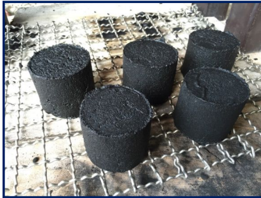
ภาพที่ 3.24 แสดงถ่านอัดแท่งที่ผ่านกระบวนการอัด
