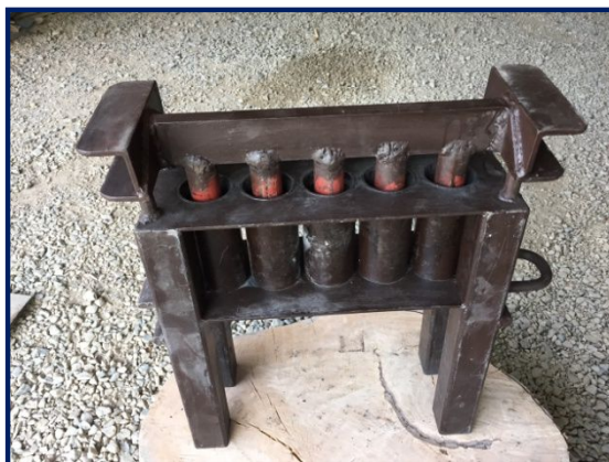
ภาพที่ 3.9 แสดงเครื่องอัดถ่านแท่ง (ใช้แรงงานคน) พัฒนาโดยคณะผู้วิจัยโครงการ
