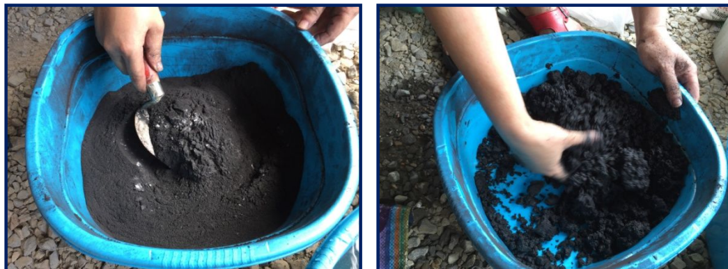
ภาพที่ 3.22 แสดงขั้นตอนการผสมผงถ่านกับแป้งมันสำปะหลัง
