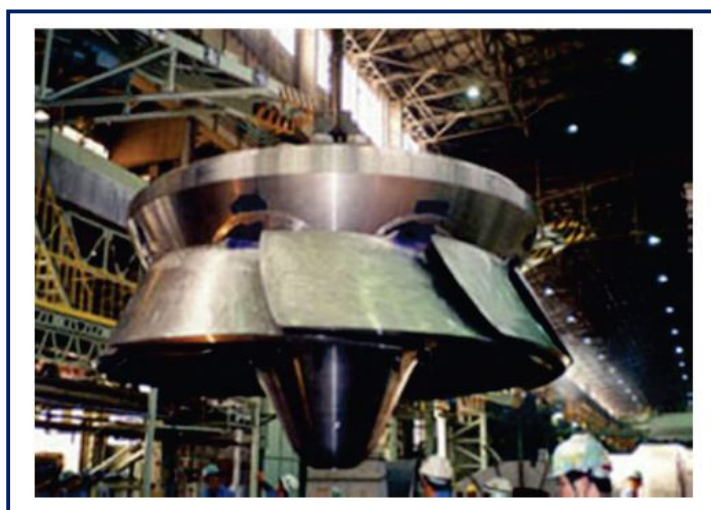
ภาพที่ 2.12 แสดงกังหันน้ำเดเรียซ (deriaz turbine) ที่มา : กรมพัฒนาพลังงานทดแทน และอนุรักษ์พลังงาน (ม.ป.ป.)
