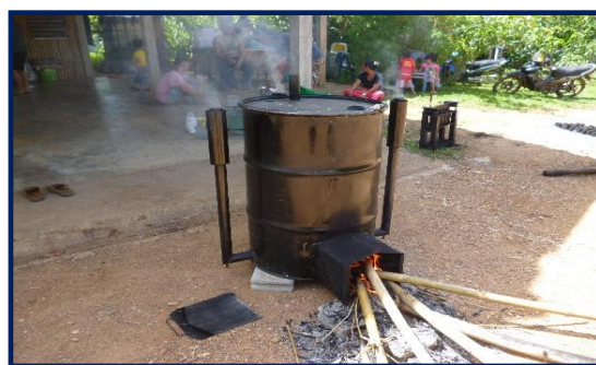
ภาพที่ 3.22 แสดงการสาธิตการผลิตถ่านโดยใช้เตาเผาผลิตถ่านแบบถัง 200 ลิตร
