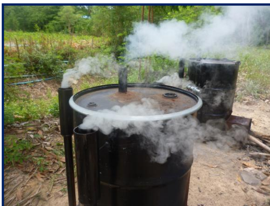
ภาพที่ 3.9 แสดงลักษณะควันในช่วงการไล่ความชื้น
