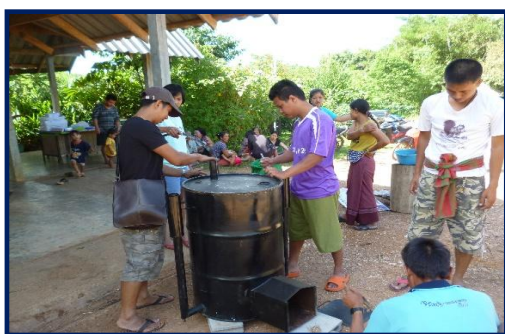
ภาพที่ 3.22 แสดงการสาธิตการผลิตถ่านโดยใช้เตาเผาผลิตถ่านแบบถัง 200 ลิตร
