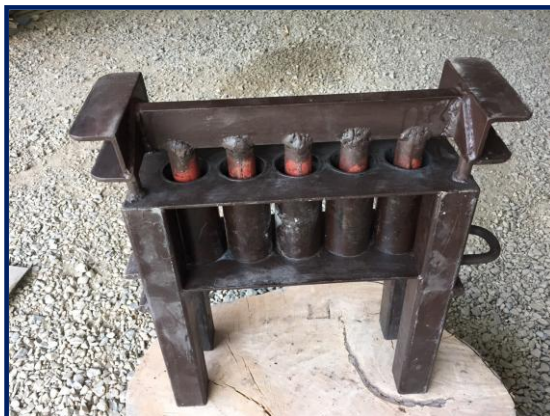
ภาพที่ 3.3 แสดงเครื่องอัดถ่านแท่ง (ใช้แรงงานคน) พัฒนาโดยคณะผู้วิจัยโครงการ
