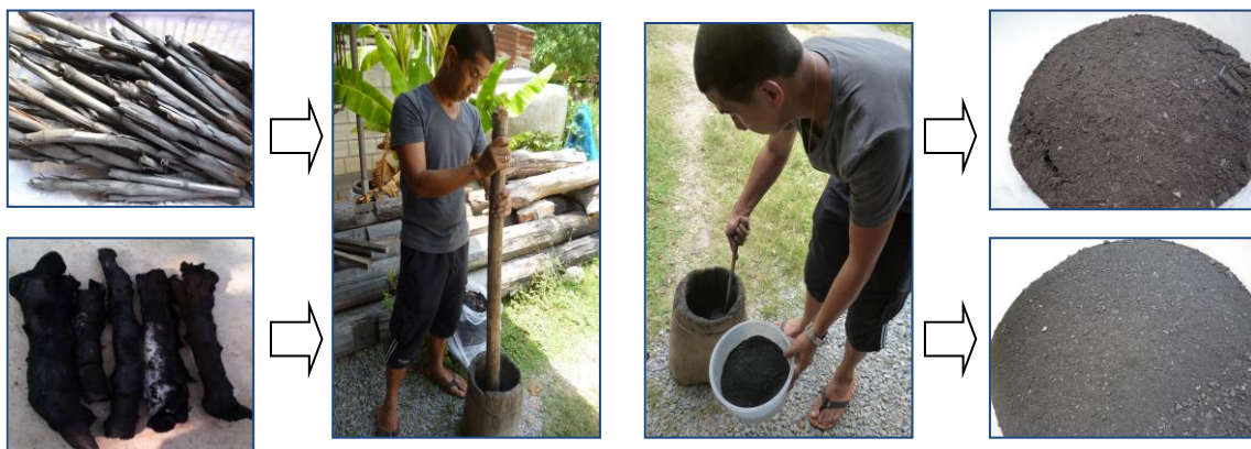
ภาพที่ 3.15 แสดงขั้นตอนการเตรียมผงถ่านหุ้ง้ำมันสำปะหลัง และต้นข้าวโพด
