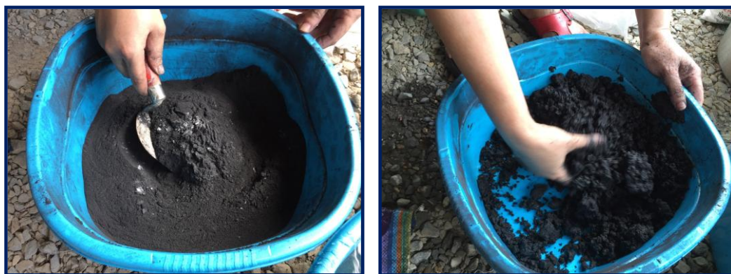
ภาพที่ 3.16 แสดงขั้นตอนการผสมผงถ่านกับแป้งมันสำปะหลัง
