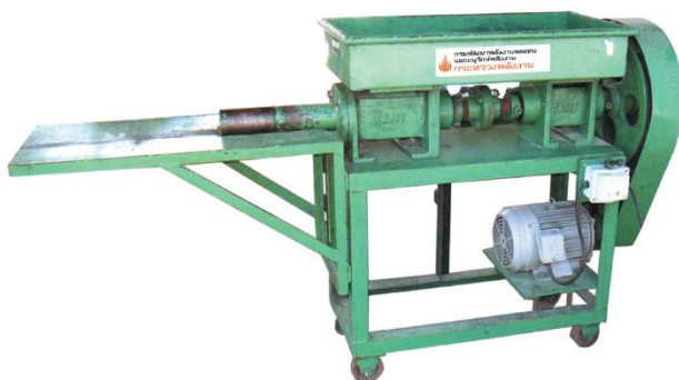
ภาพที่ 2.6 แสดงระบบอัดแท่งเชื้อเพลิงแบบอัดเย็น
