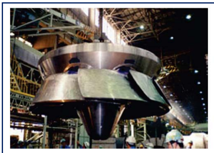
ภาพที่ 2.12 กังหันน้ำเตเรียวซ (deriaz turbine) ที่มา : กรมพัฒนาพลังงานทดแทน และอนุรักษ์พลังงาน, ม.ป.ป.
