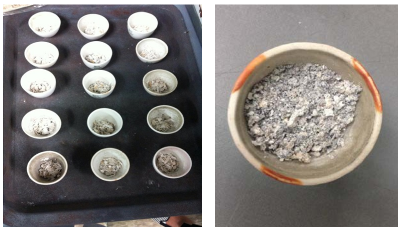
ภาพที่ 4.7 ลักษณะแก้วที่ได้จากการเผา เหง้ำมันสำปะหลัง ซังข้าวโพด และฟางข้าวมีสีขาวเทา
