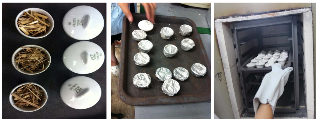
ภาพที่ 4.6 วัสดุดิบที่ผ่านการเผาที่อุณหภูมิ 600 °C เป็นเวลา 24 ชั่วโมง
