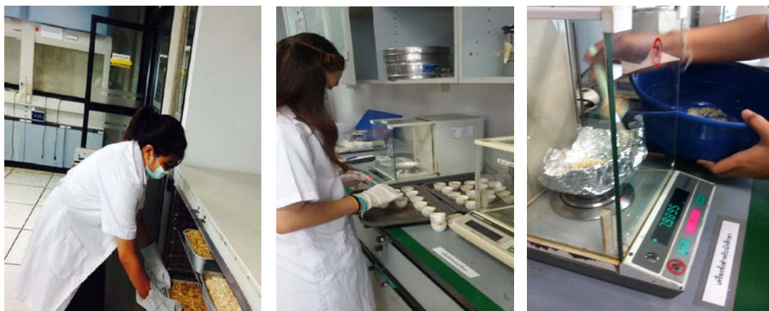
ภาพที่ 4.5 วัสดุดิบที่ผ่านการอบที่อุณหภูมิ 105 °C เป็นเวลา 24 ชั่วโมง นำไปชั่งน้ำหนัก ก่อนเผาที่อุณหภูมิ 600 °C เป็นเวลา 24 ชั่วโมง
