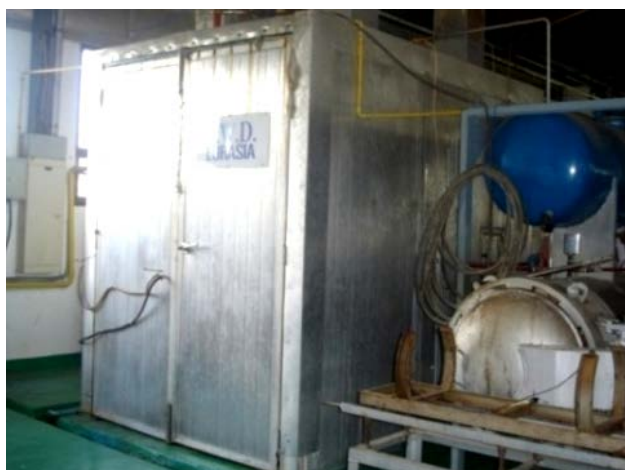
รูปที่ 3.1 เตาอบไม้ยางพาราที่ใช้ในการทดลอง (Eurasia, Singapore)
