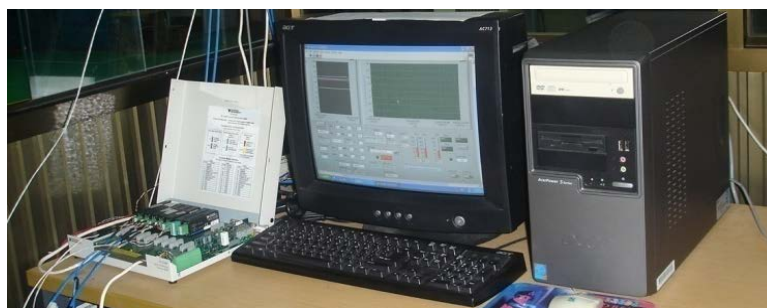
รูปที่ 3.10 อุปกรณ์และเครื่องคอมพิวเตอร์ที่ควบคุมและเก็บข้อมูลการอบด้วยโปรแกรม LabVIEW 7.1
