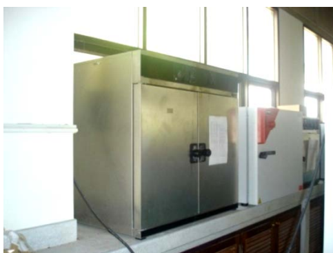
รูปที่ 3.12 เตาอบไฟฟ้า (Mettler, Germany) สำหรับอบแห้งชิ้นไม้ทดลอง
