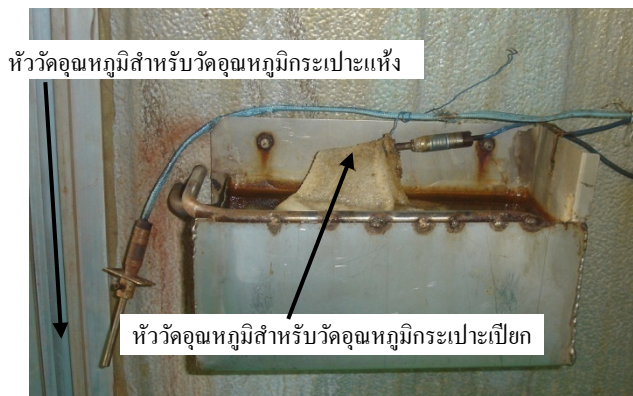
รูปที่ 3.5 อุปกรณ์วัดอุณหภูมิและความชื้นสัมพัทธ์ของอากาศภายในเตาอบ
