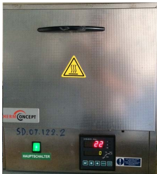
ภาพที่ 3.7 เตาเผาไฟฟ้าเผาได้สูงสุด 1200 °C
