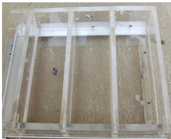
ภาพที่ 3.6 แม่พิมพ์แบบสำหรับขึ้นรูปชิ้นงานอีฐู
