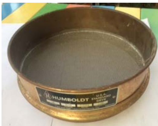
ภาพที่ 3.3 เครื่องมือที่ใช้ในการคัดกรองที่กรองอนุภาคได้ขนาดไม่เกิน 1 mm
