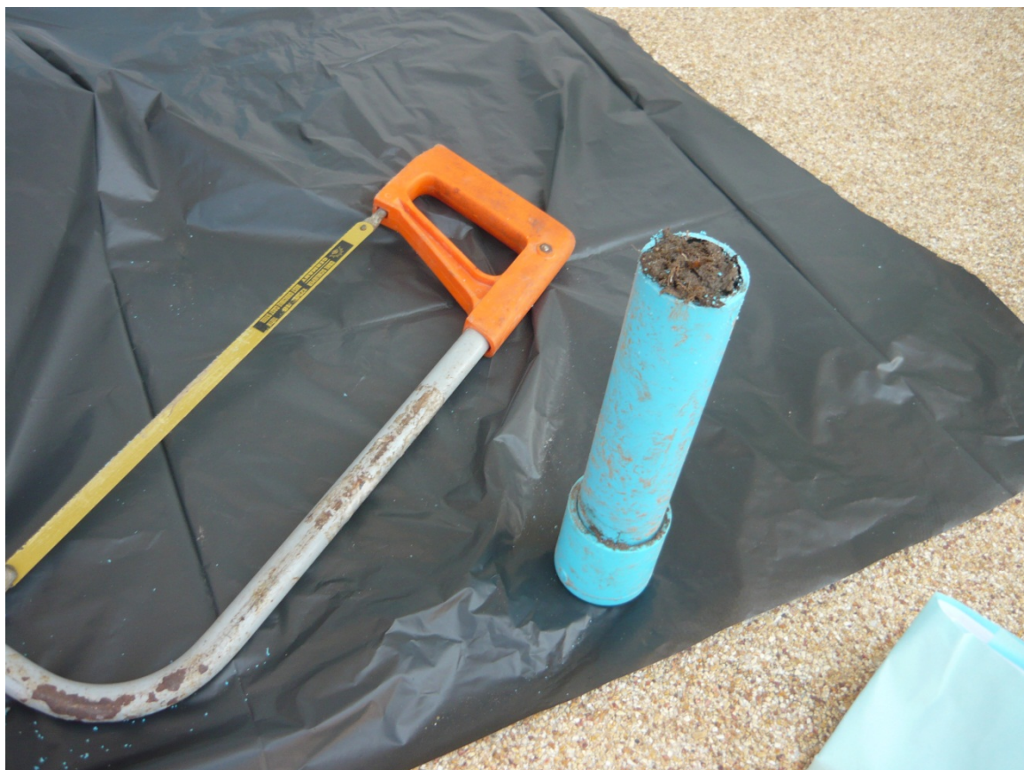
ภาพผนวกที่ ข1 อุปกรณ์เก็บตัวอย่างดินเพื่อวิเคราะห์ความชื้นในดิน
