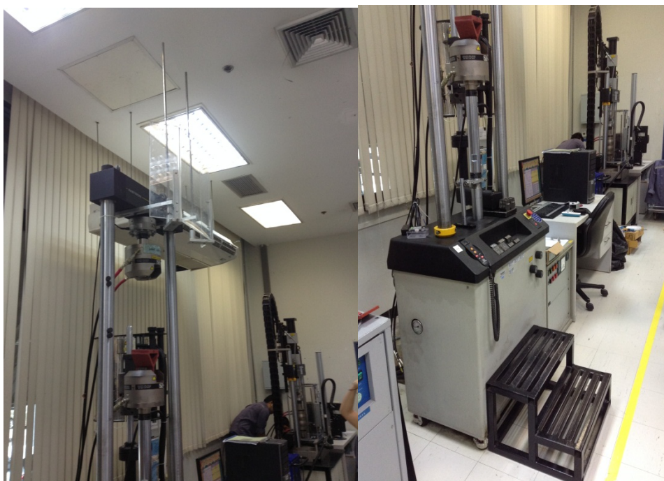
ภาพที่ 4.5 การทดสอบแรงดึงของรากต้นกระถิน
