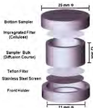
รูปที่ 1.2 แสดงภาพของอุปกรณ์เก็บอากาศแบบพาสซีฟ ที่มา : [6]
