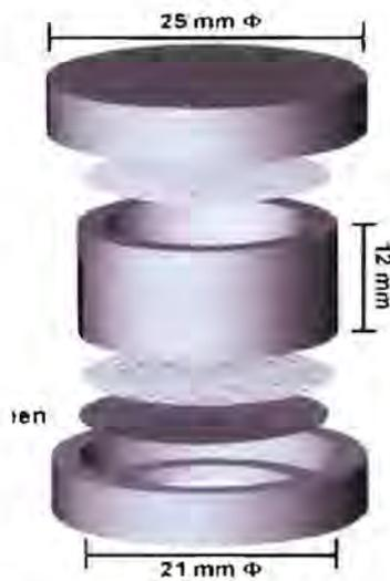
รูปที่ 2.19 แสดงอุปกรณ์เก็บอากาศแบบพาสซีฟ ที่มา : [6]
