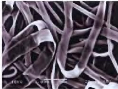
รูปที่ 2.13 แสดงเส้นใยจากกระบวนการปั่นเส้นใยด้วยไฟฟ้าสถิตของ PVA ที่มีลักษณะแบน ที่มา : [3]
