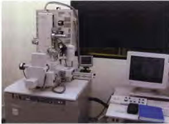
รูปที่ 2.17 แสดงเครื่อง Scanning electron microscope (SEM) ที่มา : [3]
