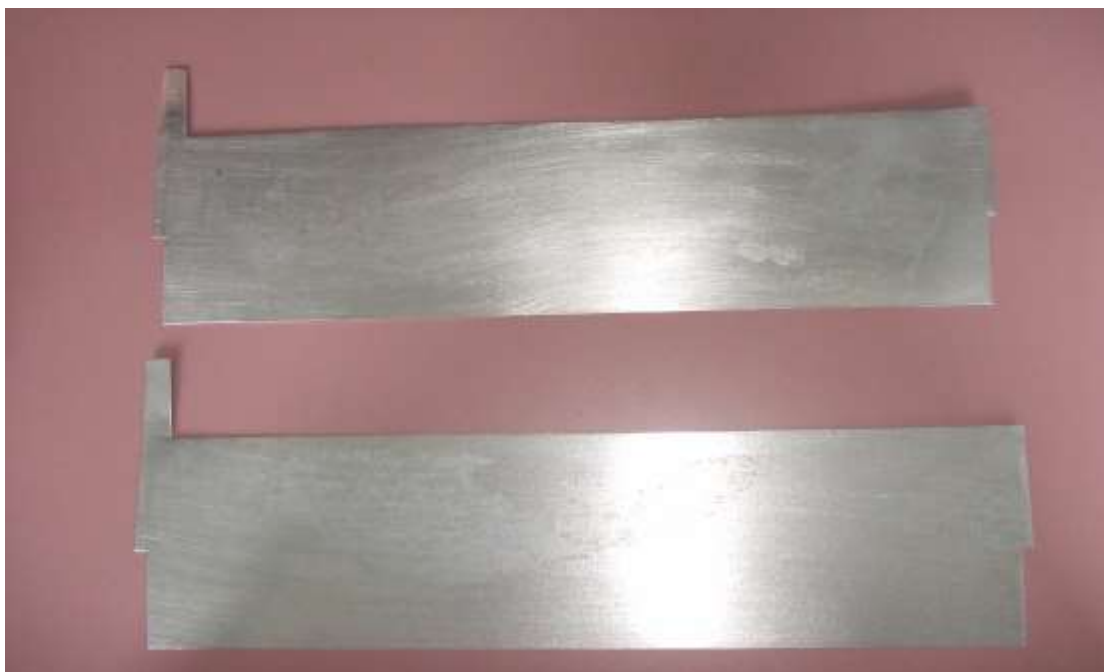
ภาพที่ 3.3 แผ่นอลูมิเนียมขนาด 300×100×1.5 มิลลิเมตร
