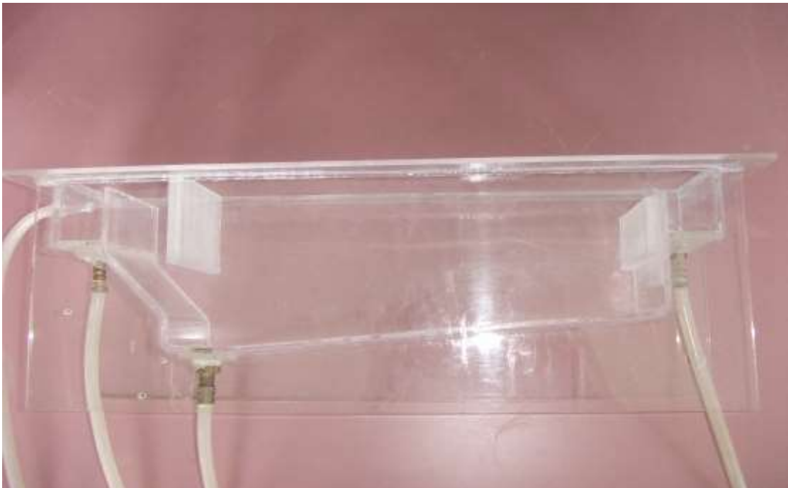
ภาพที่ 3.1 ถังปฏิกิริยา (Reactor) ขนาด 300×120×150 มิลลิเมตร
