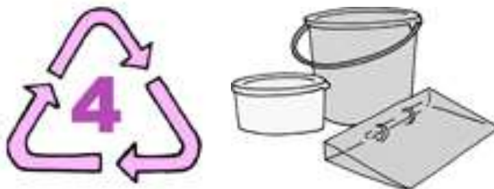
ภาพที่ 2.7 ภาพพลาสติก โพลีเอทิลีนความหนาแน่นต่ำ (Low density polyethylene, LDPE) หมายเหตุ. จาก www.stou.ac.th . โดยภูมิพัฒน์ รัตนตรัยเจริญ, 2557
