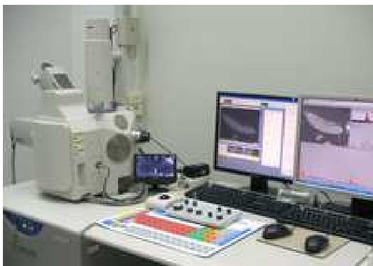
ภาพที่ 3.3 กล้องจุลทรรศน์อิเล็กตรอนแบบส่องกราด ที่มา: ศูนย์เทคโนโลยีโลหะและวัสดุแห่งชาติ. 2559
