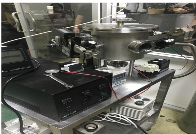
ภาพที่ 3.1 แสดงอุปกรณ์ในระบบพลาสติกที่ความดันสุญญากาศ
