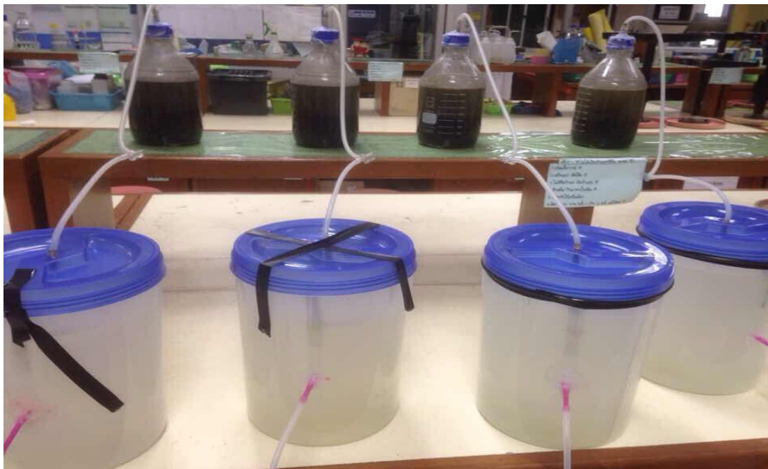
ภาพที่ 3.4 ระบบของถังปฏิกรณ์แบบแบทช์ (Batch) ในระบบจริง
