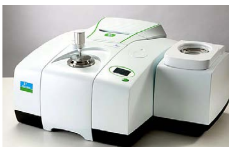
ภาพที่ 2.9 เครื่อง Fourier Transform Infrared Spectrometer (FT-IR spectrometer)
