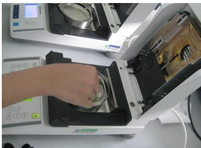
รูปที่ 3.17 แสดงการนำหนังปลาเข้าเครื่องวัดความชื้น
