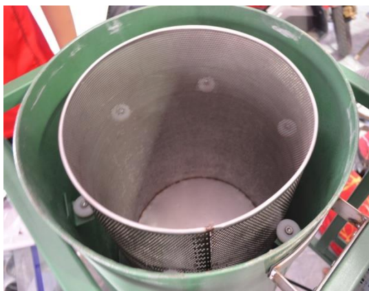
รูปที่ 3.3 แสดงลักษณะของถังภายนอกและถังภายใน(ถังปั่น)
