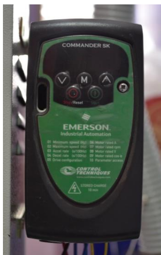
รูปที่ 3.9 แสดงลักษณะของ Inventor สำหรับควบคุมความเร็วมอเตอร์
