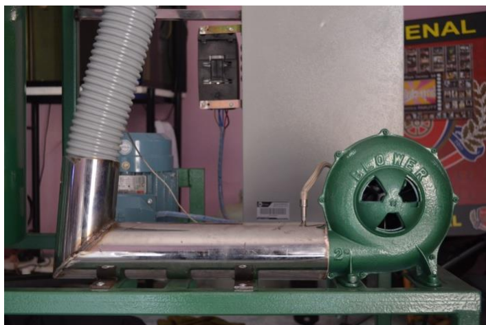
รูปที่ 3.7 แสดงลักษณะของ Blower และการต่อกับท่อยาง
