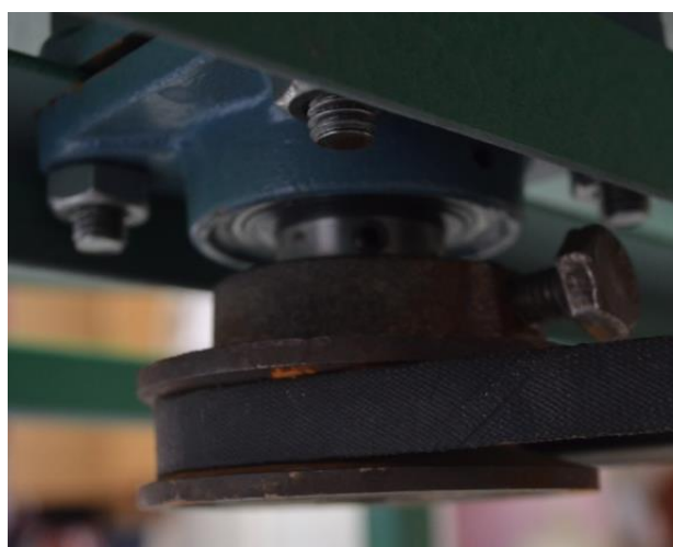
รูปที่ 3.6 แสดงลักษณะของพูลเลย์และตำแหน่งที่ติดตั้ง
