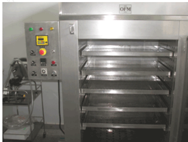
ภาพที่ 2.4 แสดงลักษณะของตู้อบลมร้อนแบบถาด
