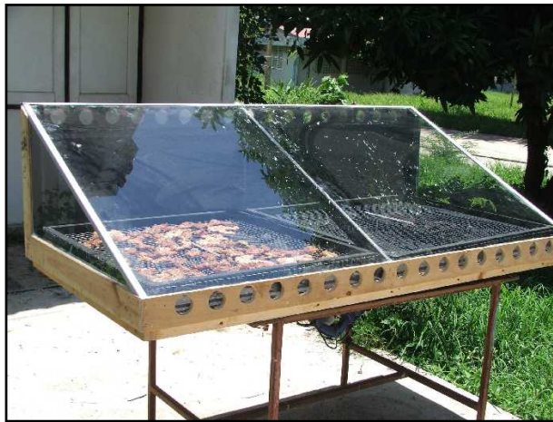
ภาพที่ 2.5 แสดงลักษณะของตู้อบแสงอาทิตย์
