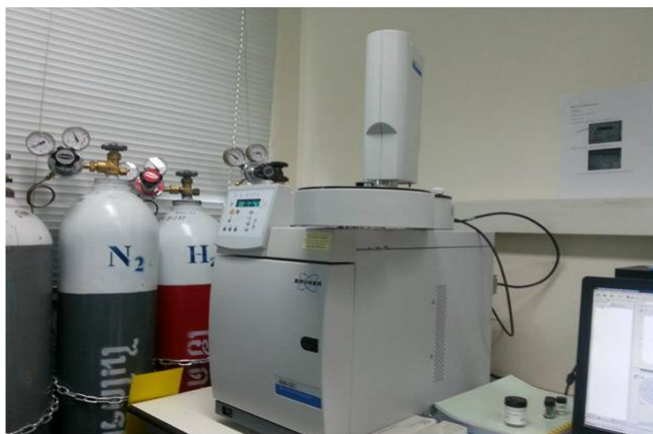
ภาพที่ 3.2 เครื่อง GC (Gas Chromatography) สำหรับวัดปริมาณเบนซิน
