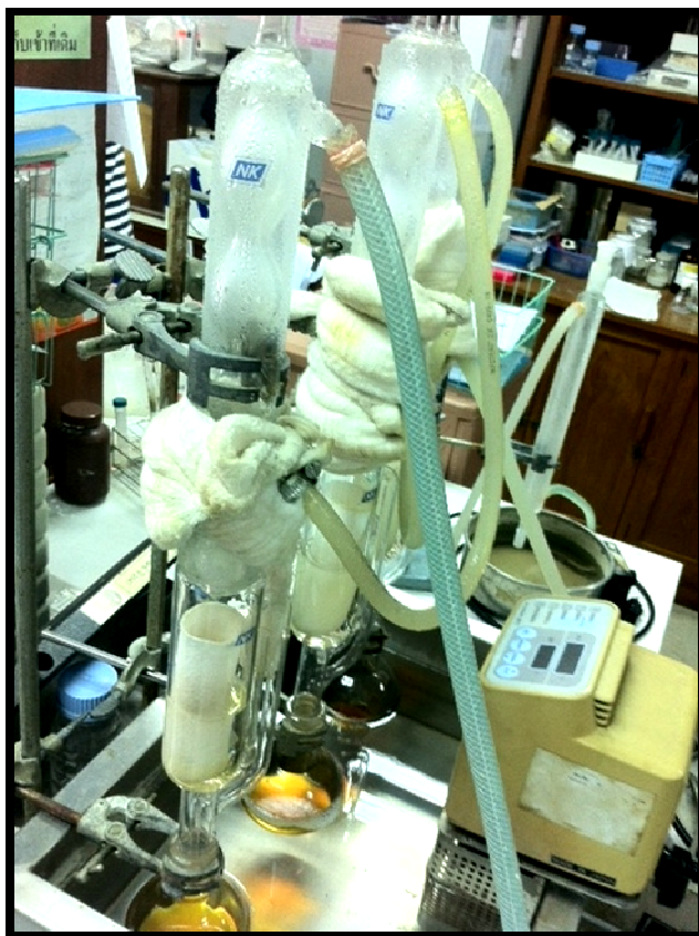
รูปภาพผนวก ก-2 ตัวอย่างที่ทำการสกัดไขมันโดยวิธี Soxhlet
