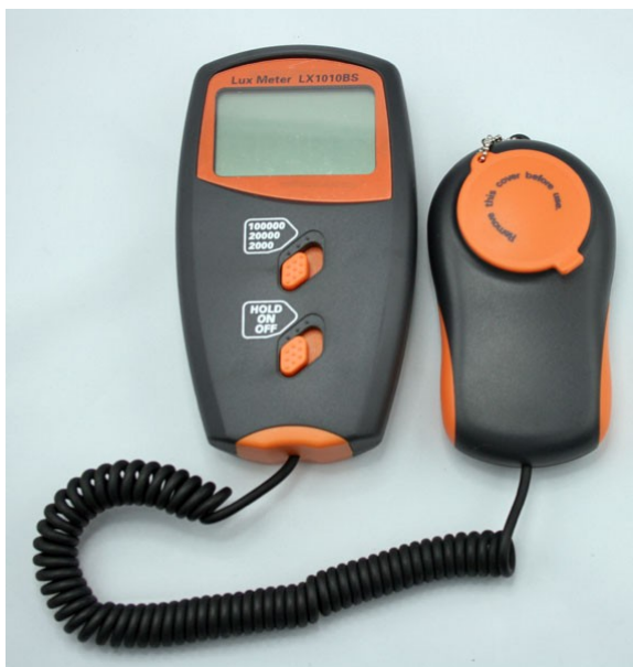
ภาพที่ 15 ลักซ์มิเตอร์ (Lux meter) รุ่น LX101BS
