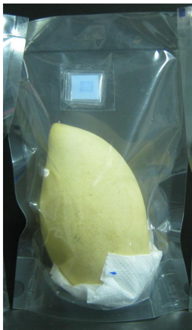
ภาพที่ II-4 ผลมะม่วงพันธุ์น้ำดอกไม้สีทองที่บรรจุในถุงพลาสติกพอลิเอไมด์ (PA) แบบช่องตั้งที่ติดแถบซีวัดปริมาณเอทานอล
