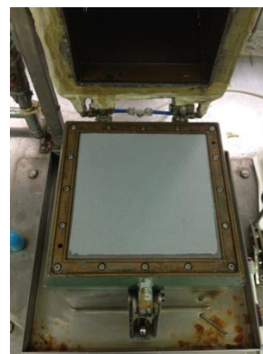
รูปที่ ก.5 กระจายตัวเชื้อด้วยเครื่อง Mixer รูปที่ ก.6 ขึ้นแผ่นกระดาดด้วยเครื่อง Hand Sheet
