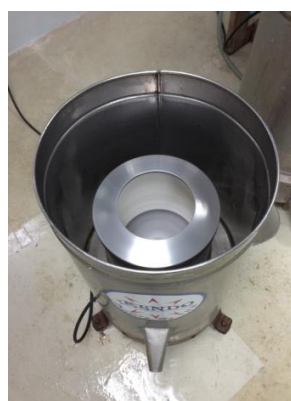
รูปที่ ก.3 บดเชื้อด้วยเครื่อง PFI Mill รูปที่ ก.4 แยกน้ำออกจากเชื้อด้วยเครื่อง Centrifuge
