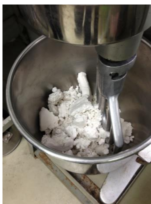
รูปที่ ก.5 กระจายตัวเชื้อด้วยเครื่อง Mixer รูปที่ ก.6 ขึ้นแผ่นกระดาดด้วยเครื่อง Hand Sheet
