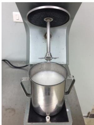
รูปที่ ก.1 ปั่นกระจายเชื้อด้วยเครื่อง Disintegrator รูปที่ ก.2 นำเชื้อกระดาดชานอ้อย
