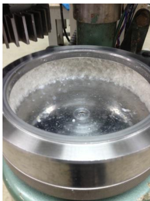
รูปที่ ก.3 บดเชื้อด้วยเครื่อง PFI Mill รูปที่ ก.4 แยกน้ำออกจากเชื้อด้วยเครื่อง Centrifuge
