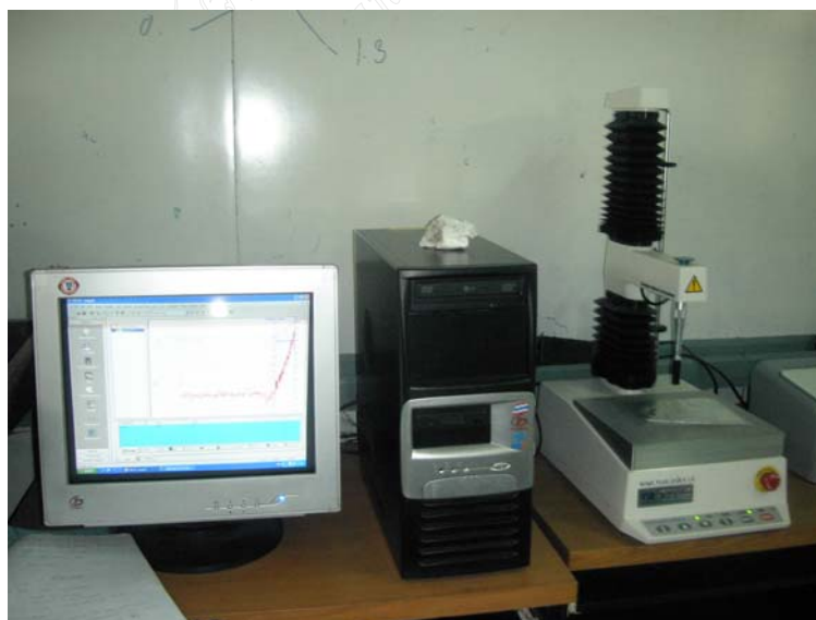
รูปที่ 2 รูปเครื่องมือวัดความแข็งแรงของเจล ไข่
