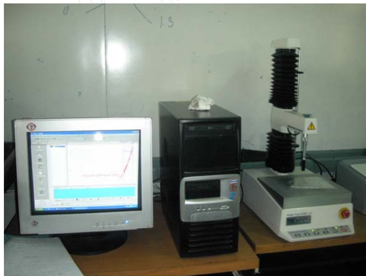
รูปที่ 2 รูปเครื่องมือวัดความแข็งแรงของเจล ไข่
