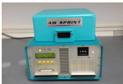
ภาพที่ ก-3 เครื่องวัดค่าปริมาณน้ำอิสระ (Water activity)
