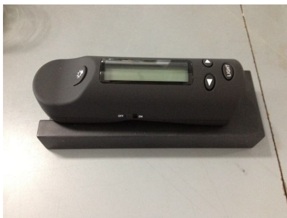
ภาพที่ ก-1 เครื่องวัดสีเครื่อง Portable Colorimeter รุ่น HPG 2132
