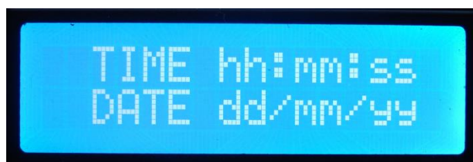
รูปที่ 4.16 หน้าจอ LCD แสดงข้อความให้ทำการตั้งค่าเวลา และวัน/เดือน/ปี
